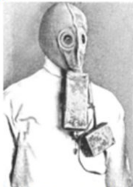
Один из первых образцов противогаза Зелинского-Кумманта
